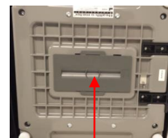
Compartimento de las baterías
