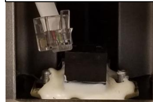
Câble de cellule de pesage non connecté
